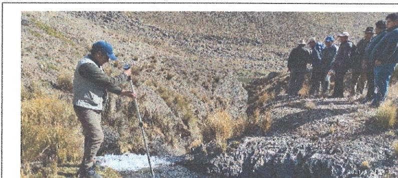
**Fotografía 1.** Inspección de campo para la elaboración del ITCP-FIV de proyectos de riego en el Departamento de La Paz, aforo de caudal sobre las fuentes de agua de la comunidad Ahijadera del municipio de Cairoma.
